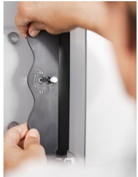
Adaptation facile aux différentes largeurs de feuilles grâce aux différentes possibilités de réglage.
